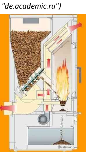
Moderner Pelletofen im Schnitt (Quelle "http://www.calimax.com/images/stories/Produkte/PELLETOEFEN/Sandor/img/sandor_schnittzeichnung.jpg")
